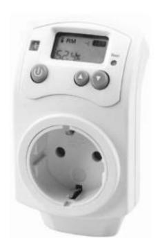
Der Steckerhygrostat HC-13101 wird zur Regulierung von Luftbe- und entfeuchtern verwendet. Der Hygrostat schaltet diese Geräte je nach programmierter Soll-Luftfeuchte (Bereich 30 – 90%) automatisch an oder ab. Hierdurch werden unnötig lange Laufzeiten vermieden sowie einer Überfeuchtung des Raumes vorgebeugt. IST- uns SOLL-Luftfeuchte sowie der aktuelle Betriebsstatus werden im Display angezeigt.
