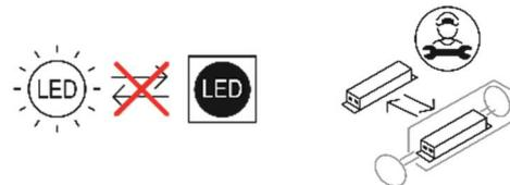
\*Schließen Sie die Leuchte nicht an ein eingeschaltetes LED-Betriebsgeräte an. Einige LED-Betriebsgeräte geben im Leerlauf eine hohe Spannung ab, was zu einer dauerhaften Beschädigung der Leuchte führen kann. Trennen Sie den LED-Betriebsgeräte unbedingt von der Netzleitung, bevor Sie die Leuchte anschließen.
