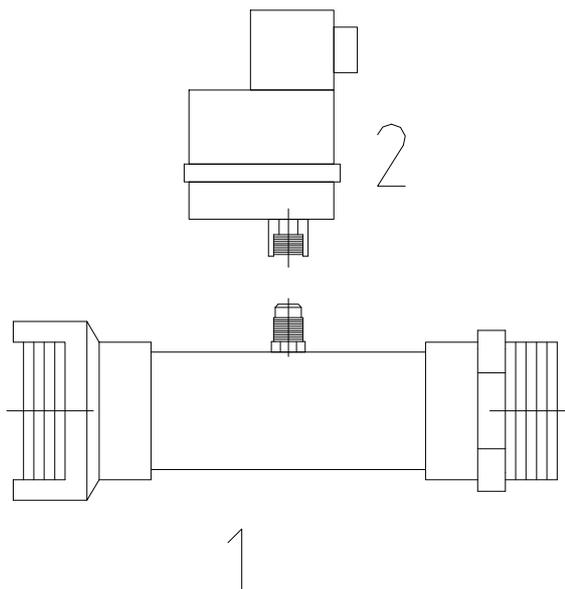
Die in der Skizze dargestellten Bauteile sind Bestandteile des gesondert zu bestellenden Zubehörs Solepressostat. Das Rohrstück ( 1 ) ist zwischen Kappenventil und Ausdehnungsgefäß im Solekreis einzubauen. Der Pressostat (2) ist mit dem am Rohrstück vorhandenem Anschlußstutzen zu verbinden.
