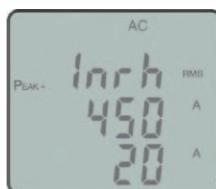
Die richtige Messung von Anlaufströmen ist unerlässlich für die Dimensionierung von elektrischen Anlagen (Hauptschalter, Relais, Sicherungen usw...).
