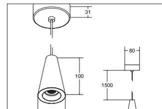
LED-Pendelleuchte KONKRET. Pendelmontage, Deckenmontage. Fassung: ohne, Montageart: Pendelmontage, Montageort: Deckenmontage, Material: Beton / Aluminium / Kunststoff, Schutzart: nach DIN EN 60529: IP20, Schutzklasse: (EN 61140) I, Spannung: 230V 50Hz, Leistung: 4,5W, Anzahl der Leuchtmittel / Fassungen: 1.0 Stk, Lichtstrom: 220lm, Farbtemperatur: 3000K, Abstrahlwinkel: 38°, mit Betriebsgerät, Art der Dimmung: schaltbar, .
