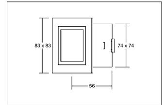
LED-Wandeinbauleuchte, aluminium, quadratisch. Einbaumontage, Wandmontage. Zum Einbau in Hohlwände mittels Blattfeder (optionales Zubehör):
