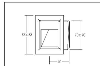
LED-Wandeinbauleuchte, aluminium, quadratisch. Einbaumontage, Wandmontage. Zum Einbau in Hohlwände mittels Blattfeder (optionales Zubehör:
