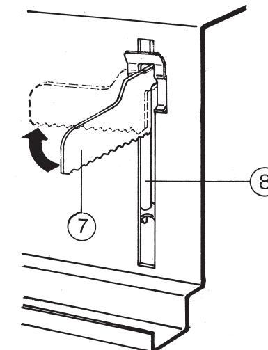
Stützhebel ⑦ durch Drehen der Stiftschraube ⑧ auf ungefähr Höhe der Deckentragschiene einstellen.
