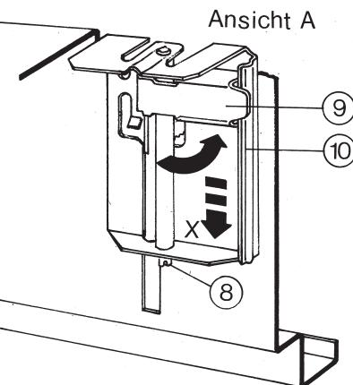
Leuchte in Deckenöffnung bis zum Anschlag an die Deckentragschiene drücken. Stützhebel ⑦ vom Leuchtengehäuse wegdrehen, bis Stützhebel hinter Rückdrehsperrre ⑩ hörbar einrastet. Per Fingerdruck (2 Finger) innenliegenden Teil ⑨ des Stützhebels ohne Verkanten in Pfeilrichtung X drücken.
