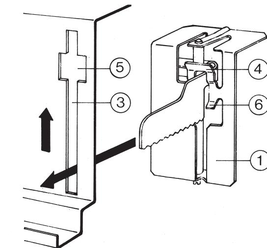
Befestigungssystem ① von innen durch Schlitz ③ stecken.
