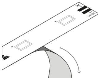
Kleben Sie den LED-Streifen niemals über eine Profilstoßstelle hinweg! Durch das physikalisch bedingte Ausdehnen bzw. Zusammenziehen des Profils bei Temperaturschwankungen kann der LED-Streifen beschädigt werden. Abhilfe schafft hier das richtige Teilen bei den Löt pads an der Stoßstelle und der Einsatz von flexiblen Verbindungen, z.B. angelötete flexible Drahtbrücken oder LED-Streifen Verbinder.
