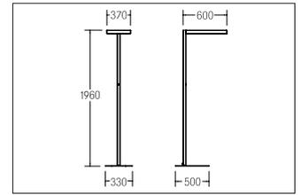
LED-Stehleuchte BIRO60, mit mikroprismatische Abdeckung und Indireken Lichtanteil, silber. Ausführung in kompakter Bauform für die harmonische Implementierung in stimmige, architektonische Raumkonzepte.
