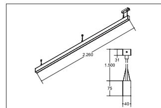
LED-Pendel-Profilleuchte direkt BIRO40, schwarz. Ausführung: LED, Montageart: Pendelmontage, Montageort: Deckenmontage, Material: Aluminium / Acryl, Schutzart: nach DIN EN 60529: IP20, Schutzklasse: (EN 61140) I, Spannung: 230V AC 50Hz, Leistung: 62,7W, Lichtstrom: 4.850lm, Farbtemperatur: 3000K, Lichtfarbe: weiß, Abstrahlwinkel: 80°, Verstellbarkeit: nicht verstellbar, mit Betriebsgerät.
