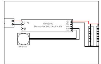
LED-Dimmer 24 V DC, DALI-, 1-10 V-, PUSH-dimmbar. LED-Dimmer einkanalig (einfarbig) für Konstantspannungsbetrieb (24 V DC). Die Verkabelung erfolgt über Steckklemmen. Leitungsquerschnitt: 0,5 - 2,5 mm<sup>2</sup>. Zum Betrieb wird eine externe Spannungsversorgung benötigt. Ausgangssignal (Dimmung): PWM (Pulsweitenmodulation). Mit Überlast-, Kurzschluss-, Übertemperatur- und Leerlaufschutz, max. Ausgangsstrom: 5 A.
