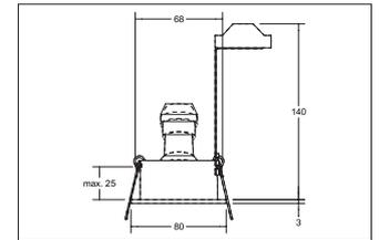
Einbaustrahler, GU10, weiß, rund. Ausgeführt in kompakter Bauform für werkzeuglose Schnellmontage zum Deckeneinbau. Inkl. Bügel mit GU10-Fassung zur normgerechten Zugentlastung. Ausführung: GU10, Montageart: Einbaumontage, Montageort: Deckenmontage, Material: Aluminium, Schutzart: nach DIN EN 60529: IP20, Schutzklasse: (EN 61140) II, Spannung: 230V AC 50Hz, Leistung: 50W, Anzahl der Leuchtmittel / Fassungen: 1.0 Stk, Verstellbarkeit: schwenkbar, ohne Betriebsgerät, Art der Dimmung: sonstige .
