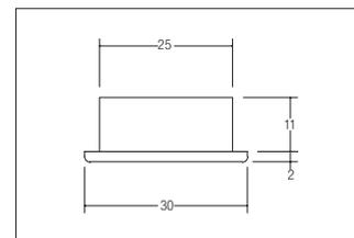
LED-Lichtpunkt, chrom, rund. Ausgeführt in kompakter Bauform für werkzeuglose Schnellmontage zum Deckeneinbau. Fassung: Plug&Play 350mA, Montageart: Einbaumontage, Montageort: Deckenmontage, Material: Aluminium / Kunststoff, Schutzart: nach DIN EN 60529: IP20, Schutzklasse: (EN 61140) III, Strom: 350 mA, Leistung: 1W, Anzahl der Leuchtmittel / Fassungen: 1.0 Stk, Lichtstrom: 40lm, Farbtemperatur: 3000K, Abstrahlwinkel: 100°, Verstellbarkeit: nicht verstellbar, .
