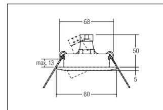
Einbaustrahler, weiß, rund. Ausgeführt in kompakter Bauform für werkzeuglose Schnellmontage zum Deckeneinbau. Fassung: GX5,3, Montageart: Einbaumontage, Montageort: Deckenmontage, Material: Stahl, Schutzart: nach DIN EN 60529: IP20, Schutzklasse: (EN 61140) III, Spannung: 12V, Leistung: max. 50W, Anzahl der Leuchtmittel / Fassungen: 1.0 Stk, Verstellbarkeit: schwenkbar, ohne Betriebsgerät, Art der Dimmung: sonstige, .
