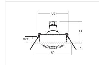
Einbaustrahler, schwarz, rund. Ausgeführt in kompakter Bauform für werkzeuglose Schnellmontage zum Deckeneinbau. Fassung: GX5,3, Montageart: Einbaumontage, Montageort: Deckenmontage, Material: Stahl / Messing, Schutzart: nach DIN EN 60529: IP20, Schutzklasse: (EN 61140) III, Spannung: 12V, Leistung: max. 50W, Anzahl der Leuchtmittel / Fassungen: 1.0 Stk, Verstellbarkeit: schwenkbar, ohne Betriebsgerät, Art der Dimmung: sonstige, .
