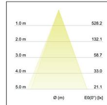
LED-Einbaustrahler INDIWO83, schwenkbar, dim2warm, weiß, rund. Ausgeführt in kompakter Bauform für werkzeuglose Schnellmontage zum Deckeneinbau. Wird die Leuchte gedimmt, verringert sich die Farbtemperatur.
