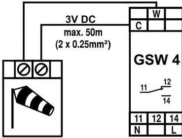
Abb. 1: Anschluss Windsensor
