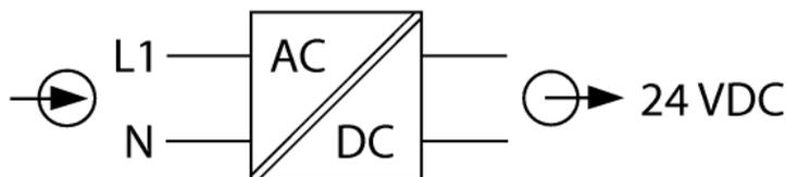
Der AC/DC-Umsetzer PPSA115Ex dient der Versorgung des excom®-Systems bis zum Vollausbau. Der Umsetzer ist in einer kombinierten Schutzart Ex m und Ex e ausgeführt und kann daher in Zone 1 eingesetzt werden. Es ist vollvergossen in einem Aluminium-Schutzgehäuse eingebaut.
