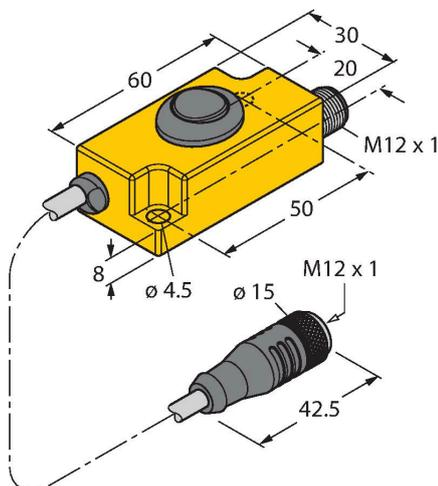
Teach-Adapter u. a. für induktive Drehgeber, Linearweg-, Winkel-, Ultraschall- und kapazitive Sensoren
