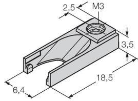
Zubehör zur Sicherung des Schaltpunktes auf  $\square$  T-Nutzylindern; In die Zubehöraufnahmen des Sensors BIM-UNT einschnappbar; Werkstoff: Kunststoff
