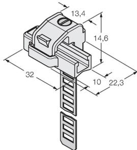
Klemmstück zur Montage von Magnetfeldsensoren auf  $\odot$  Rundzylindern; Zylinderdurchmesser: 8...25 mm; Werkstoff: PA 6I/6T / Neusilber; Brandklassifikation nach UL94 - V2
