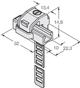
Klemmstück zur Montage von Magnetfeldsensoren auf  $\odot$  Rundzylindern; Zylinderdurchmesser: 130...250 mm; Werkstoff: PA 6I/6T / Neusilber; Brandklassifikation nach UL94 - V2
