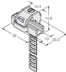
Klemmstück zur Montage von Magnetfeldsensoren auf  $\odot$  Rundzylindern; Zylinderdurchmesser: 63...130 mm; Werkstoff: PA 6I/6T / Neusilber; Brandklassifikation nach UL94 - V2
