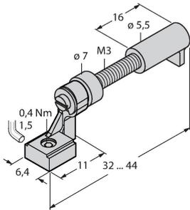
Zubehör zur Feinjustage des Schaltpunktes auf  $\square$  T-Nutzylindern; in die Zubehöraufnahmen des Sensors BIM-UNT einschnappbar; zur Mehrfachverwendung geeignet; Werkstoff: Metall / Kunststoff
