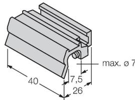
Zubehör zur Montage des Sensors BIM-INT und BIM-UNT auf  $\odot$  Zugankerzylinder; Zylinderdurchmesser: 32...40 mm; Werkstoff: Aluminium; weitere Zusatzhalterungen für unterschiedliche Zylinderdurchmesser auf Anfrage
