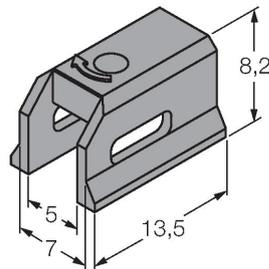
Klemmstück zur Montage von Magnetfeldsensoren auf  $\square$  Schwalbenschwanznutzylinder; Nutbreite: 7 mm; Werkstoff: PPS
