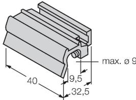
Zubehör zur Montage des Sensors BIM-INT und BIM-UNT auf  $\odot$  Zugankerzylinder; Zylinderdurchmesser: 50...63 mm; Werkstoff: Aluminium; weitere Zusatzhalterungen für unterschiedliche Zylinderdurchmesser auf Anfrage
