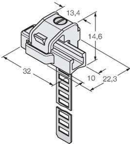
Klemmstück zur Montage von Magnetfeldsensoren auf  $\odot$  Rundzylindern; Zylinderdurchmesser: 25...63 mm; Werkstoff: PA 6I/6T / Neusilber; Brandklassifikation nach UL94 - V2
