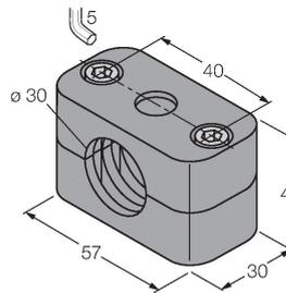
Befestigungsschelle für Glatt- und Gewinderohrsensoren; Werkstoff: Polypropylen
