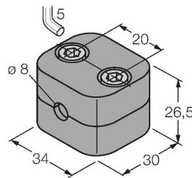
Befestigungsschelle für Glatt- und Gewinderohrsensoren; Werkstoff: Polypropylen
