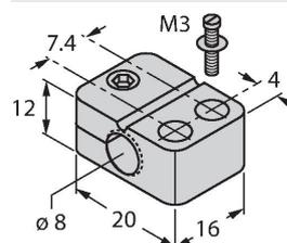
Befestigungsschelle für Gewinderohrsensoren, mit Festanschlag; Werkstoff: PA6
