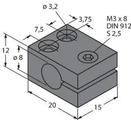
Befestigungsschelle für Gewinderohrsensoren; Werkstoff Montageblock: Aluminium, eloxiert
