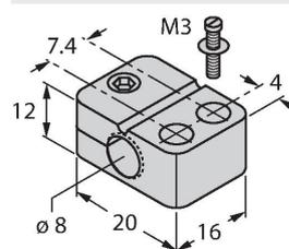
Befestigungsschelle für Gewinderohrsensoren, mit Festanschlag; Werkstoff: PA6
