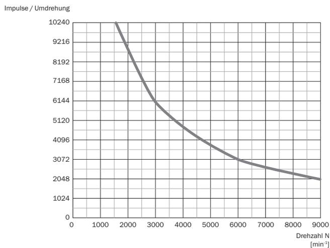
Signalausgänge für elektrische Schnittstellen TTL und HTL
