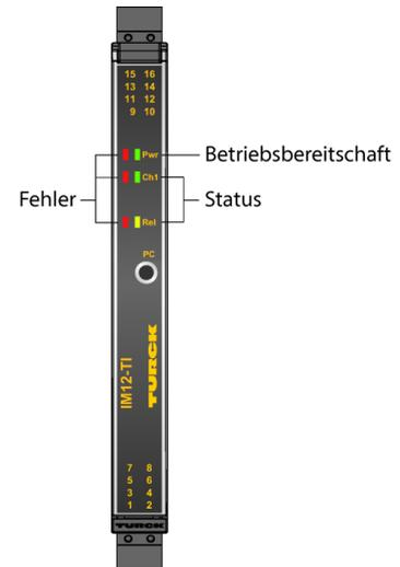
Der Temperatur-Messumformer IM12-TI02-1TCURTDR-111R-CPR/24VDC/CC überträgt temperaturabhängige Messwerte galvanisch getrennt. Die Geräte sind für den Betrieb in Zone 2 geeignet.
