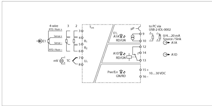
Der 1-kanalige Temperatur-Messverstärker IM12-TI02-1TCURTDR-1I1R-C0/24VDC verfügt über Eingänge für: Thermoelemente nach IEC 60584, DIN 43710, GOST R 8.585-2001, Kleinspannungen (-150...+150 mV), RTDs nach IEC 60751, DIN 43760, GOST 6651-94 (2-, 3- und 4-Leiter) sowie Widerstände 0...5 kΩ (2-, 3- und 4-Leiter)..
