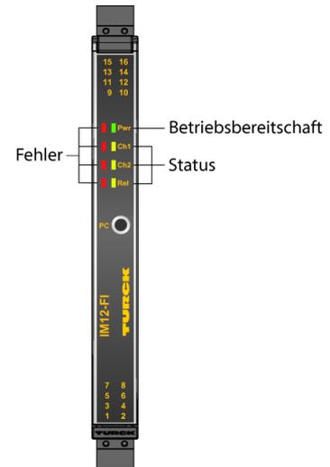
Der Frequenzmessumformer/Puls-Counter IM12-FI01-1SF-111R-C0/24VDC/CC überträgt Frequenzsignale bis 20000 Hz galvanisch getrennt. Zusätzlich können Grenzwerte, Schlupf oder Rechts-/Links-Lauf überwacht werden. Die Geräte sind für den Betrieb in Zone 2 geeignet.
