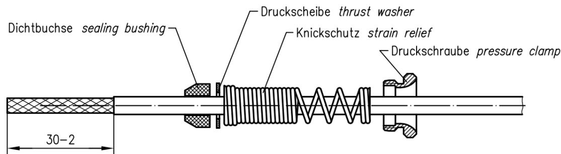
1. Druckschraube, Knickschutz, Druckscheibe und Dichtbuchse in dieser Reihenfolge auf das Kabel aufschieben /
