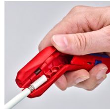
Abmanteln eines Koaxialkabels
