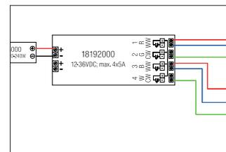
TunableWhite-Funkfernbedienung zu 18192000. TunableWhite-Funkfernbedienung zur Ansteuerung von zweifarbigen LED-Modulen im Weißlichtbereich.
