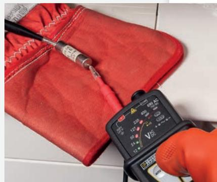
Bei Spannungsfreiheit lässt sich durch Drücken der Taste  $\Omega$  schnell eine Durchgangsprüfung starten.
