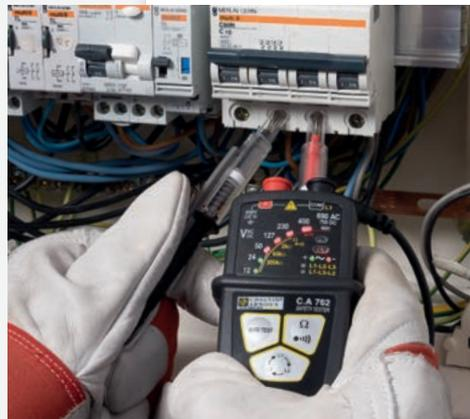
Die Drehfeldrichtungsanzeige ist schnell und einfach, auch bei Stromkreisen mit Trenn-Transformator.
