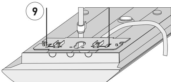
Ⓓe Zugentlastung auf das Einspeisekabel aufziehen und das Kabel wie abgebildet einfädeln.
