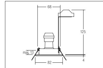
Hochvolt-Einbaustrahler GU10, weiß, rund. Ausgeführt in kompakter Bauform für werkzeuglose Schnellmontage zum Deckeneinbau. Inkl. Hochvoltbügel zur normgerechten Zugentlastung. Fassung: GU10, Montageart: Einbaumontage, Montageort: Deckenmontage, Material: Stahl / Messing, Schutzart: nach DIN EN 60529: IP20, Schutzklasse: (EN 61140) II, Spannung: 230V AC 50Hz, Leistung: max. 50W, Anzahl der Leuchtmittel / Fassungen: 1.0 Stk, Verstellbarkeit: schwenkbar, Art der Dimmung: sonstige, .
