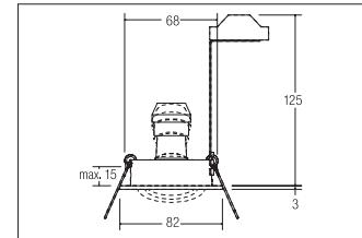
Hochvolt-Einbaustrahler GU10, weiß. Ausgeführt in kompakter Bauform für werkzeuglose Schnellmontage zum Deckeneinbau. Inkl. Hochvoltbügel zur normgerechten Zugentlastung. Fassung: GU10, Montageart: Einbaumontage, Montageort: Deckenmontage, Material: Aluminium, Schutzart: nach DIN EN 60529: IP20, Schutzklasse: (EN 61140) II, Spannung: 230V AC 50Hz, Leistung: max. 50W, Anzahl der Leuchtmittel / Fassungen: 1.0 Stk, Verstellbarkeit: schwenkbar, ohne Betriebsgerät, Art der Dimmung: sonstige, .
