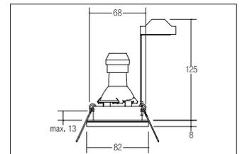
Hochvolt-Einbaudownlight GU10 IP65, weiß, rund. Ausgeführt in kompakter Bauform für werkzeuglose Schnellmontage zum Deckeneinbau. Inkl. Hochvoltbügel zur normgerechten Zugentlastung. Fassung: GU10, Montageart: Einbaumontage, Montageort: Deckenmontage, Material: Guss / Glas, Schutzart: nach DIN EN 60529: IP65\*, Schutzklasse: (EN 61140) II, Spannung: 230V AC 50Hz, Leistung: max. 50W, Anzahl der Leuchtmittel / Fassungen: 1.0 Stk, Verstellbarkeit: nicht verstellbar, Art der Dimmung: sonstige, .
